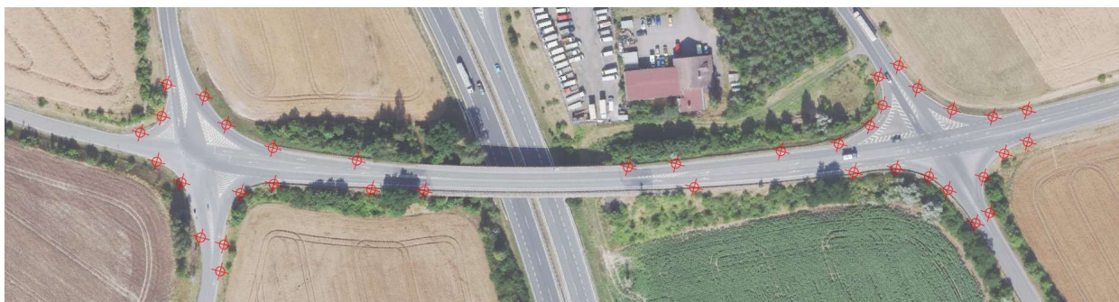
Obrázek 2 – Ukázka geodetického zaměření bodů v řešené lokalitě. [40]
